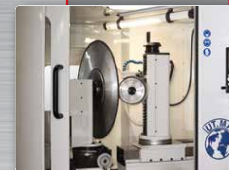
AC 800 Affûtage du couteau diamètre 800 mm
